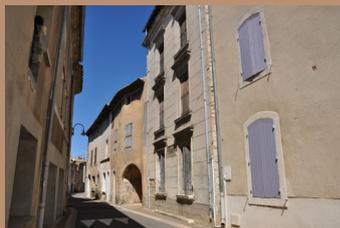
Jean Marc BARREAU constate que le sol de la ruelle PERROT a été imperméabilisé au moyen de béton, qui empêche la respiration des maçonneries et va se dégrader dans le temps. Elle aurait mérité une calade. Le parcours se poursuit par la visite de l'Hôtel de Suze, propriété de
